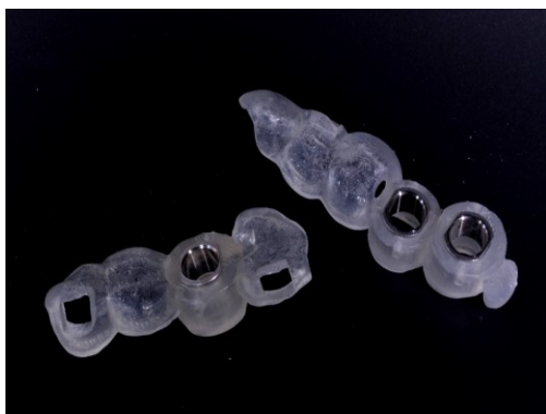
Slika 8. Popolnoma polimerizirana kirurška vodila po mehanski obdelavi
