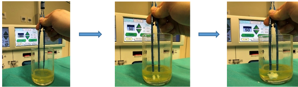
Slika 10. Prikaz aktivacije bipolarne pincete v jajčnem beljaku brez stika aktivnih elektrod
