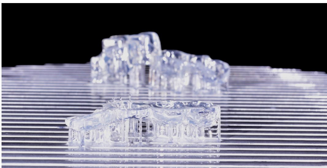
Slika 7. Popolnoma polimerizirana kirurška vodila pred mehansko obdelavo
