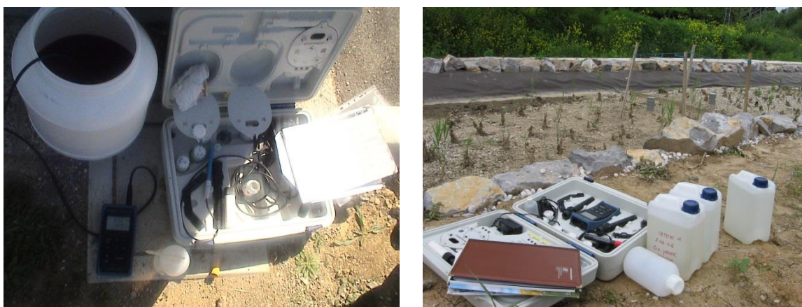
Slika 23: Terenska oprema za monitoring rastlinske čistilne naprave.
