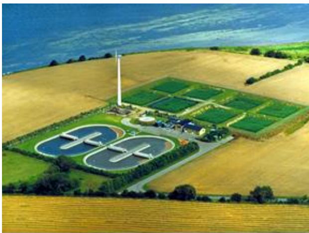
Slika 39: Trstne kompostne grede v Rudkøbingu na Danskem (Steen Nielsen).
