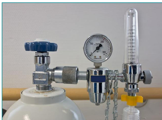
Slika 10: Kisikova jeklenka (levo), barometer (v sredini) in regulator pretoka kisika z vlažilcem (desno); Pixabay, 2024
