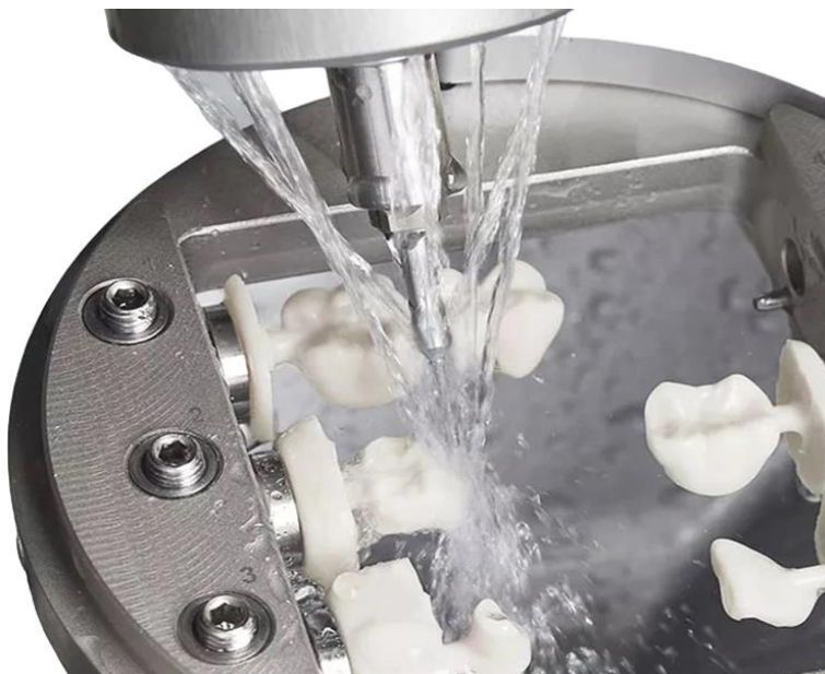
Slika 60: Mokra obdelava litijevega disilikata (lastni vir).
