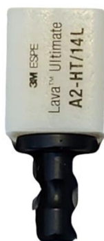
Slika 79: Blok surovca s polimerno matrico in keramičnimi nanodelci (lastni vir).
