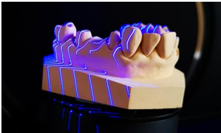
Slika 21: Projekcija svetlobe z optičnimi črtami v laboratorijskem optičnem bralniku (lastni vir).
