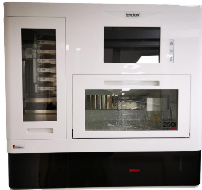
Slika 48: Kompaktna petosna rezkalna enota za suho in mokro rezkanje (lastni vir).
