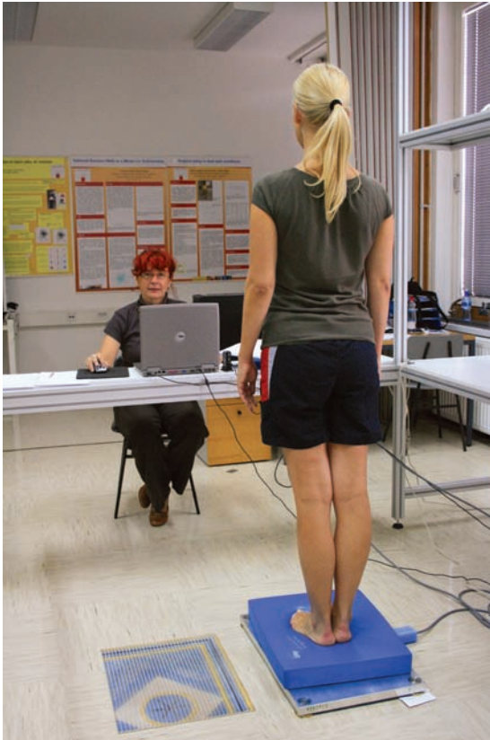
Izvedba stabilometričnih meritev v biomehanskem laboratoriju.
