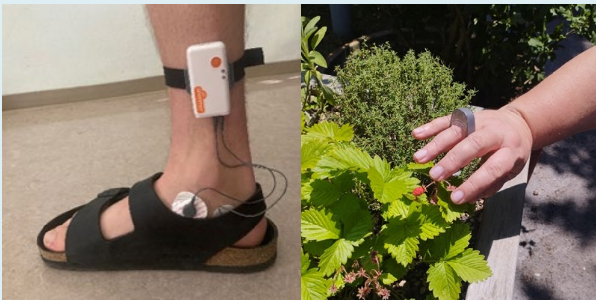
Sliki 32 in 33: Primer merjenja EDA z merilnikom Shimmer in Biopac prstanom (vir: Arhiv projekta, 2025)
